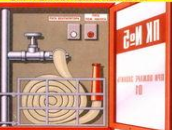
ВНУТРЕННИЙ ПОЖАРНЫЙ КРАН
